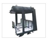
Встроенный каркас безопасности кабины
